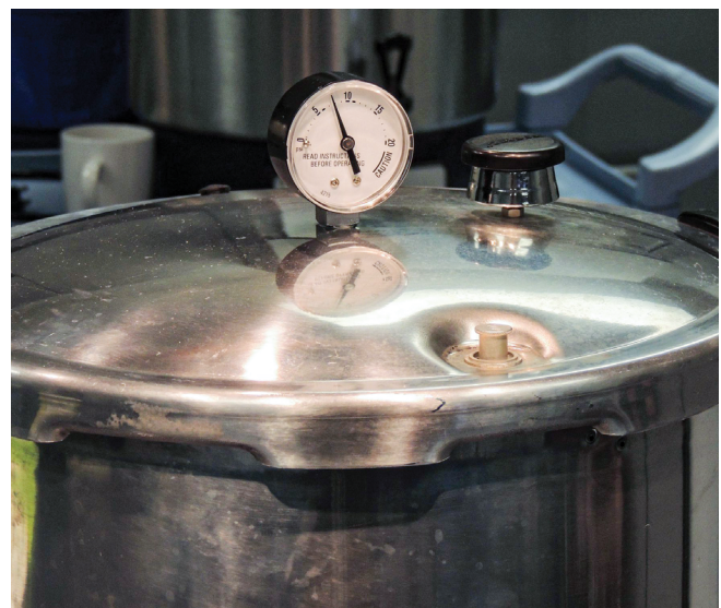
Figura 6. El manómetro de dial es un instrumento delicado y debe someterse a pruebas de precisión cada año.
