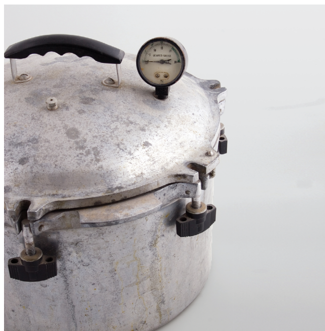
Figura 10. Una enlatadora a presión con corrosión y oxidación.
