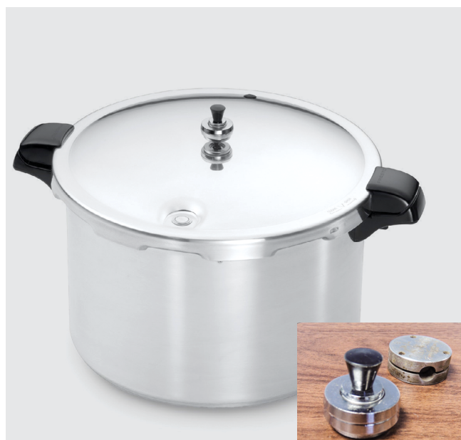
Figura 8. Las enlatadoras con manómetro de peso utilizan una pequeña pesa redonda o un disco en el tubo de ventilación de la enlatadora a presión (recuadro) para controlar la presión interna.
